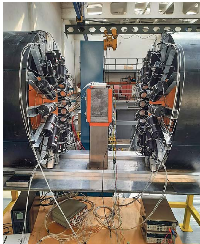
В центре установки расположен источник, излучающий позитроны
